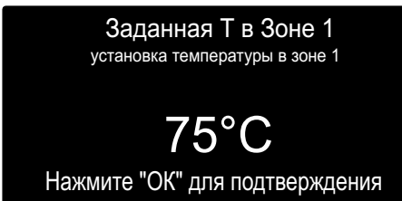
Изменение температуры горячей воды отопления
