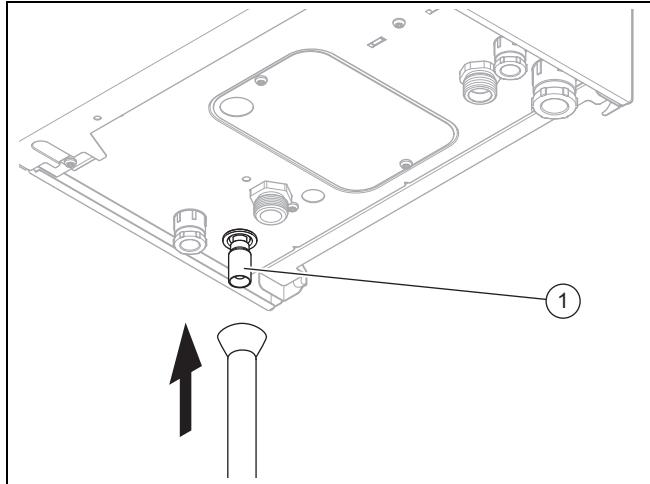
1. С помощью заливной воронки присоедините сливной трубопровод к сливу (1). предохранительного клапана.
