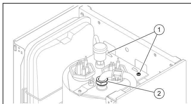
5. Выверните крепежный винт (2). обратной линии системы отопления на верхней стороне теплообменника.
