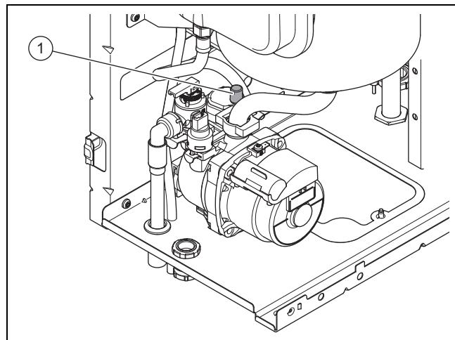
1. Открутите колпачок быстродействующего воздухоотводчика (1). на насосе на один-два оборота.
