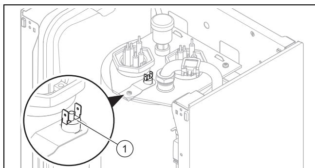
1. Отсоедините оба разъема от предохранительного ограничителя температуры (1)..
