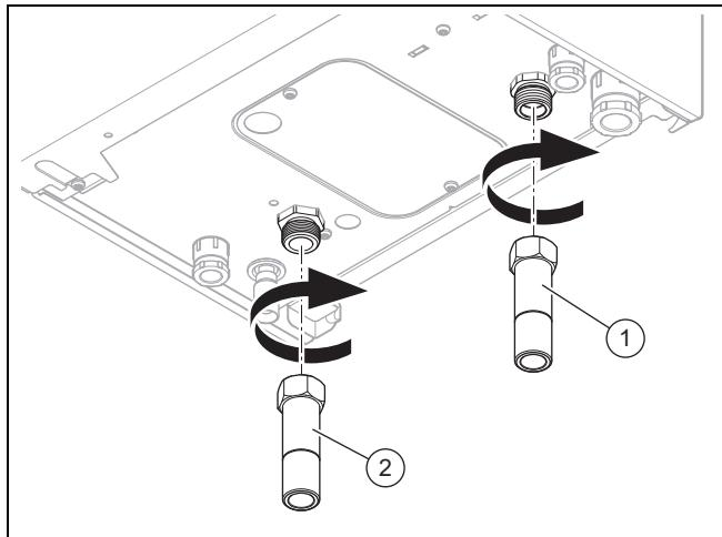
1. Присоедините трубопровод подающей линии системы отопления (1). к патрубку подающей линии системы отопления.
