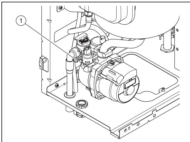
1. Снимите стопорную скобу (1), и извлеките предохранительный клапан из изделия.
