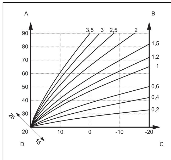
A: Температура в подающей линии в °C
