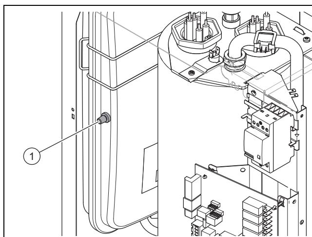
8. Перед заполнением системы отопления измерьте давление на входе расширительного бака при отсутствии давления в отопительном приборе на штуцере для проведения измерений (1). расширительного бака.
