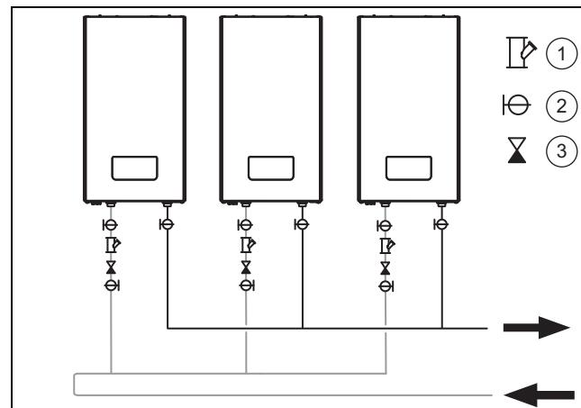
Если мощность изделия не может скомпенсировать теплопотери в здании, то подключите дополнительный прибор из этой серии мощностью 24 или 28 кВт.
