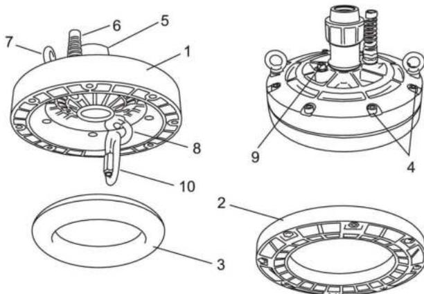
Оголовок состоит из крышки (1), нижнего прижимного фланца (2), уплотнительного резинового кольца (3) и восьми стяжных болтов с шайбами и гайками (4).
