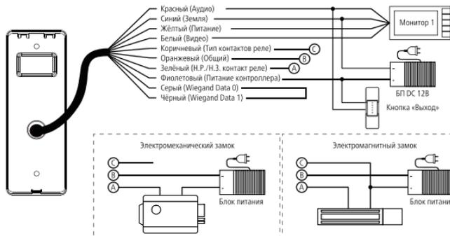
Рис. 4 Подключение панели в режиме автономного контроллера
