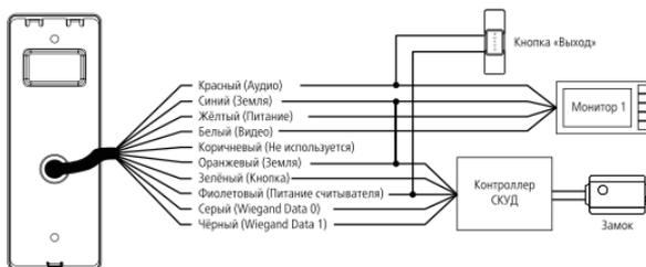
Рис. 5 Подключение панели в режиме считывателя
