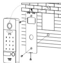
Рис. 3 Установка видеопанели
