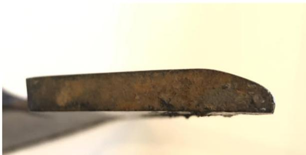
Рис. 2. Затупление режущей кромки
