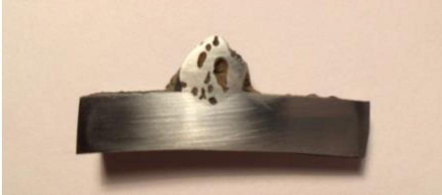
Рисунок 1. Дефектный участок валика
