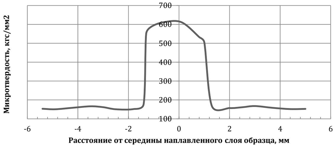
График 2. Распределение микротвёрдости по ширине наплавленного слоя
