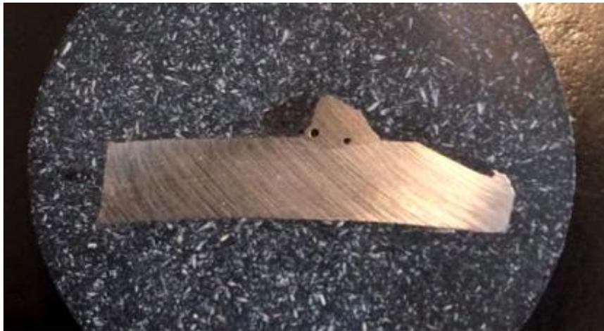
Рисунок 2. Менее дефектный участок валика
