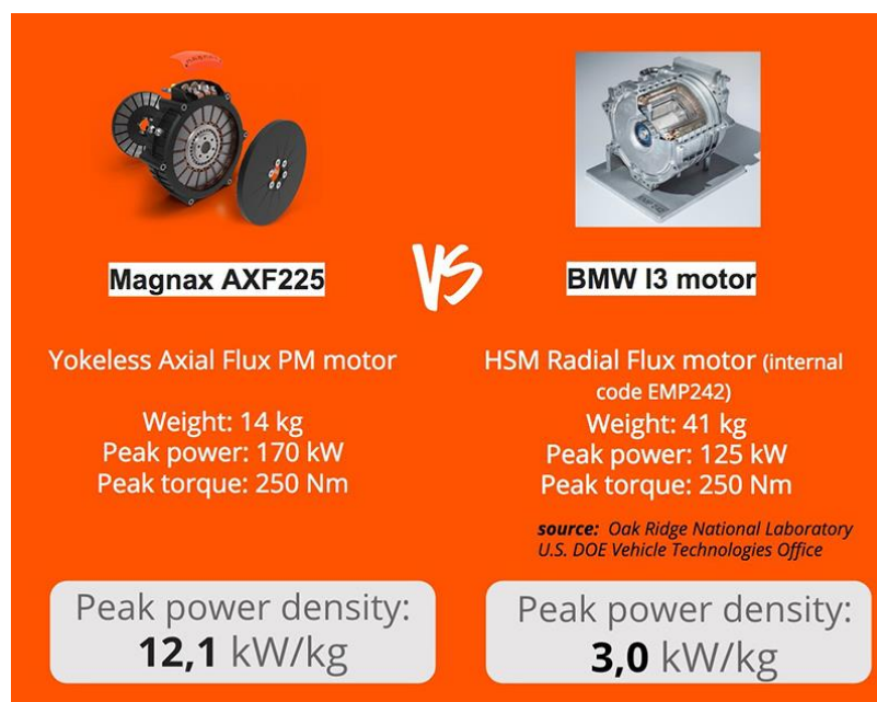
Рисунок 2. Сравнение мотора BMW I3 и Magnax AXF225.
