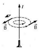
Если ток направлен от нас, то линии магнитной индукции направлены по часовой стрелке (по правилу буравчика), а если ток направлен к нам, то против часовой стрелки.
