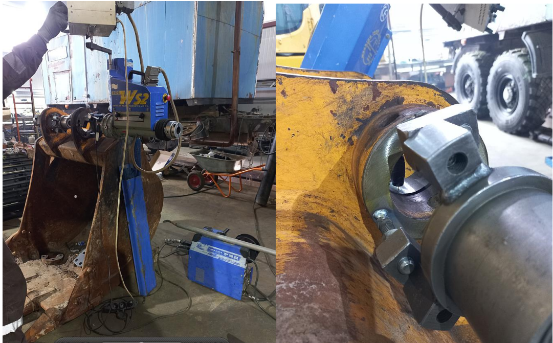
Рис. 3 Мобильный расточно-наплавочный станок WS2
