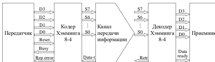
Рисунок 6. Схема моделируемого устройства
