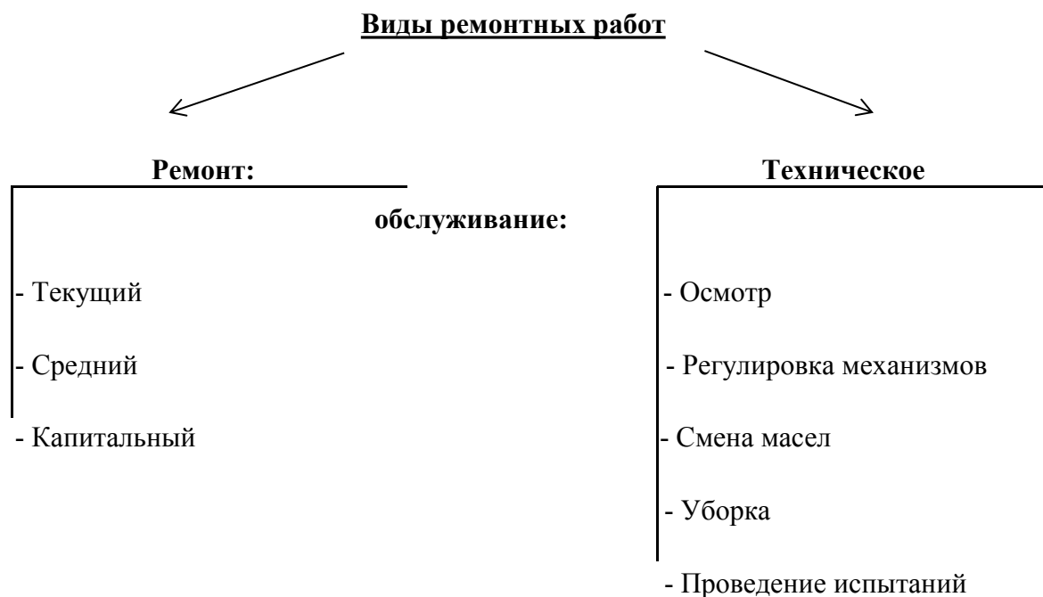
Рисунок 1. Виды ремонтных работ.
