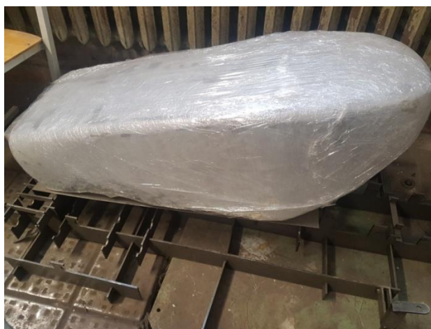
Рисунок 3 – Матрица для изготовления носового обтекателя
