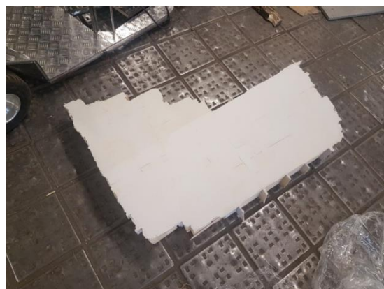
Рисунок 2 – Матрица для изготовления боковой панели
