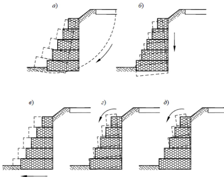
Рис.1. Проверки для массивной подпорной стены:
