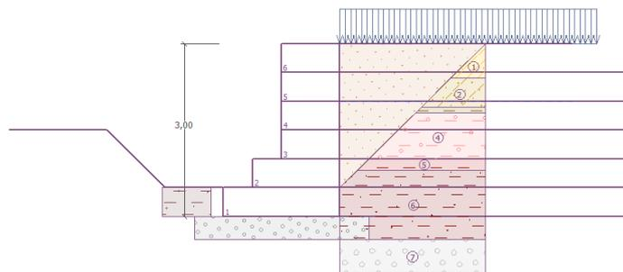
Рис.4. Устройство подготовки из щебня под подошвой габиона
