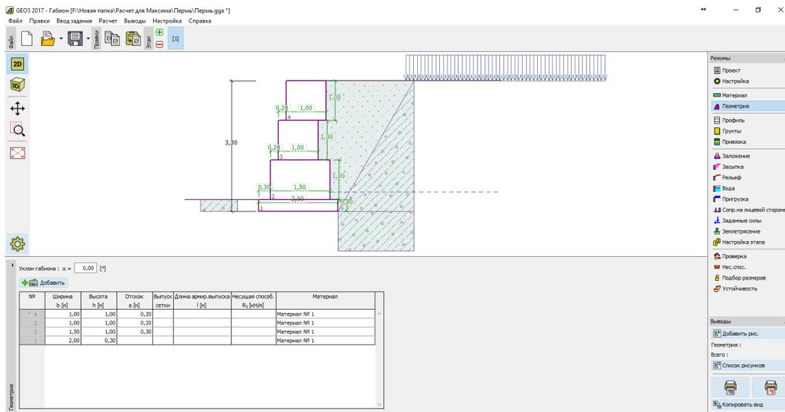
Рис.2. Расчетная схема габиона
