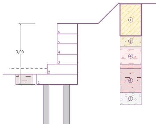
Рис.5. Устройство опоры из свай под подошвой габиона
