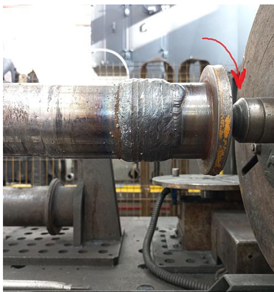
Рис. 2 Наплавка валика на палец стрелы (направление вращения)
