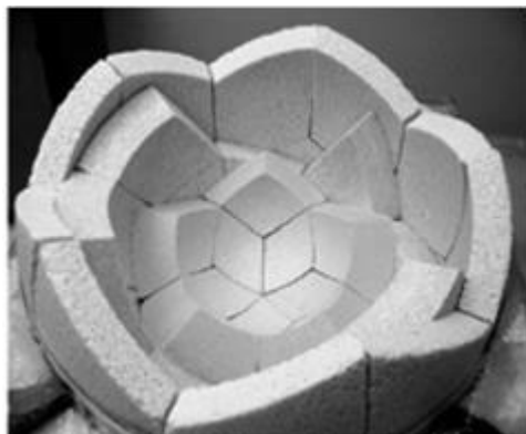
Рис. 3 – Конструктивная реализация многослойной линзы
