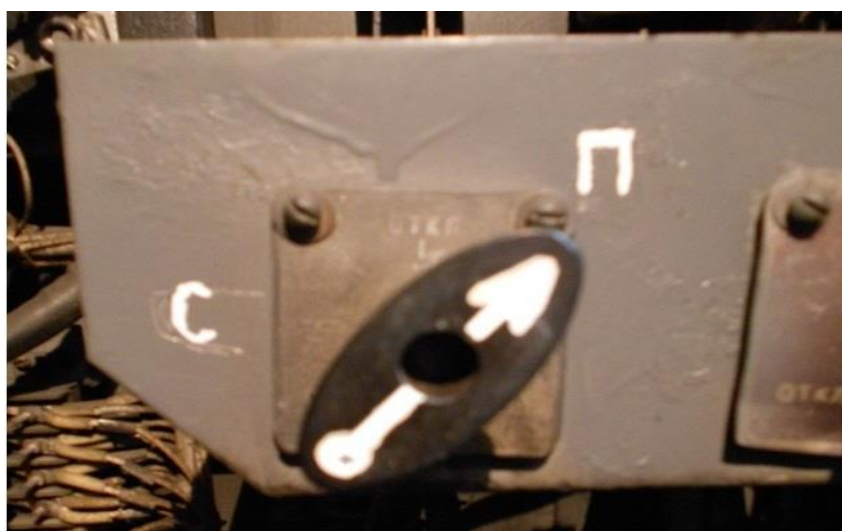
Рисунок 12 – положение пакетного переключателя в поездном режиме
