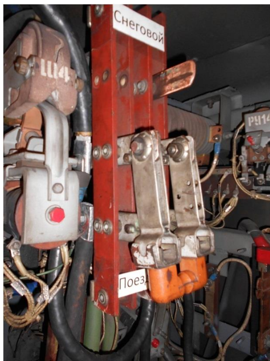
Рисунок 11 – положение переключателя РШК №56 поездном режиме
