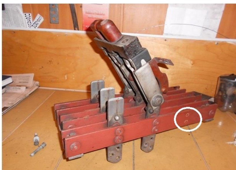
Рисунок -1 – трёхножевой разъединитель серии РШК №56
