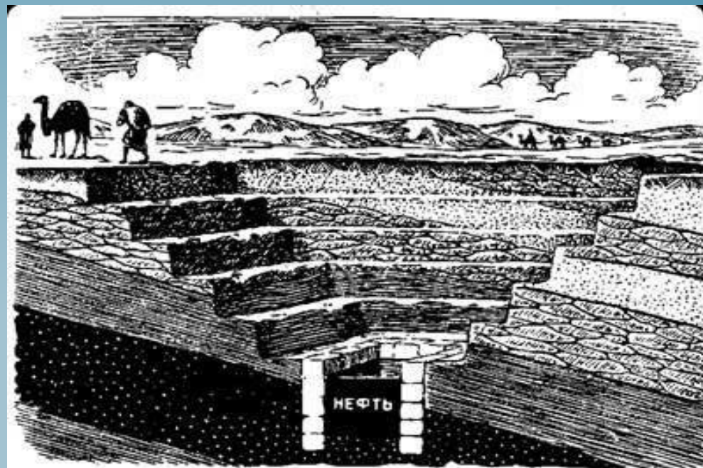
Разрез старого нефтяного колодца
