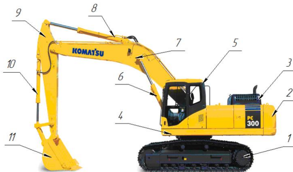
Рис. 1 Одноковшовый полноповоротный гусеничный экскаватор Komatsu PC 300: 1 – гусеничное ходовое устройство; 2 – противовес; 3 – силовая установка; 4 – поворотная платформа; 5 – кабина оператора; 6 – гидроцилиндр стрелы; 7 – стрела; 8 – гидроцилиндр рукояти; 9 – рукоять; 10 – гидроцилиндр ковша; 11 – ковш [3]
