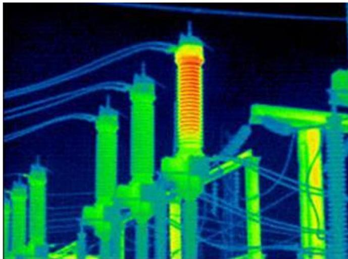
Рисунок 3 – Изображение ОПН, снятое с экрана тепловизора
