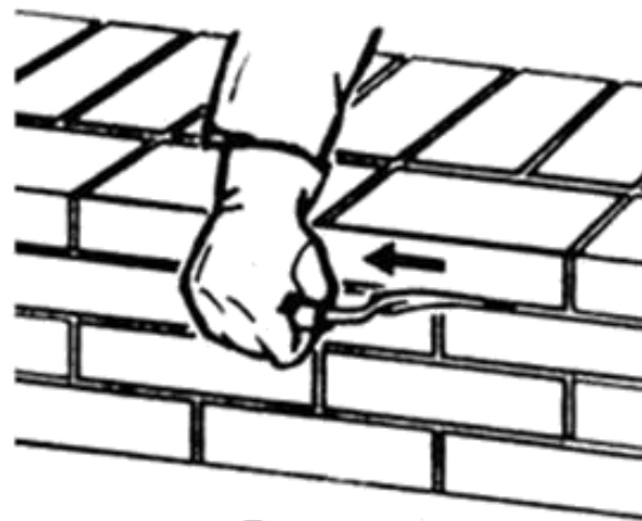
Расшивка горизонтальных швов
