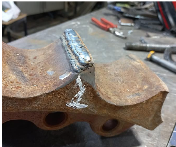
Рис. 5 Образец наплавленного валика
