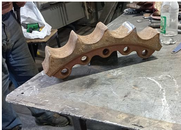
Рис. 3 Образец сегмента для наплавки
