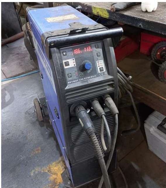
Рис. 4 Сварочный источник питания Aurora PRO SKYWAY 330 SYNERGIC
