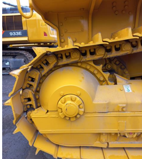
Рис.2 Сегмент ведущей звезды бульдозера
