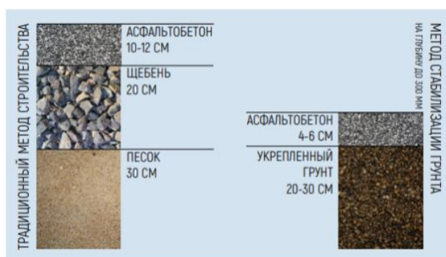
Рис. 1. Сравнение конструкции дорог
