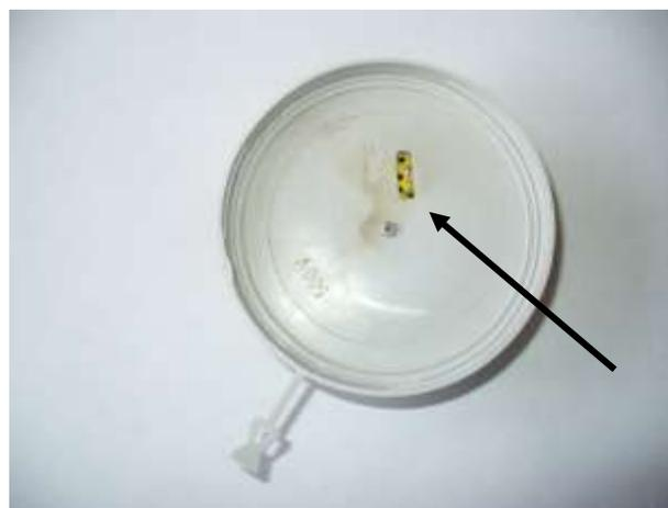
**Рисунок 3. Опытный образец №1 электронного прибора индикаторного типа для мониторинга возникновения аварийного режима работы, вызванного большим переходным сопротивлением.**
