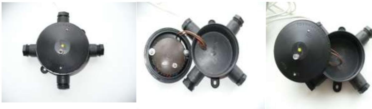
**Рисунок 4. Опытный образец № 2 электронного прибора индикаторного типа для мониторинга возникновения аварийного режима работы, вызванного большим переходным сопротивлением.**
