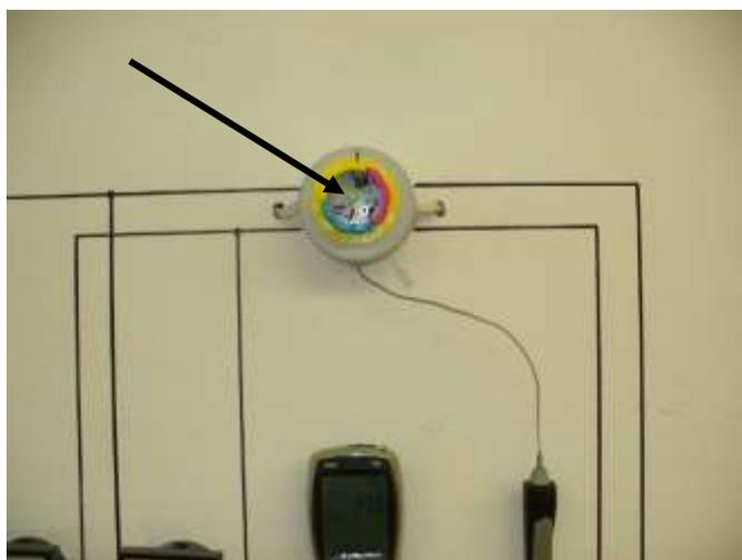
**Рисунок 5. Испытание опытного образца электронного прибора индикаторного типа для мониторинга возникновения аварийного режима работы, вызванного большим переходным сопротивлением. Стрелкой черного цвета указано на горящий индикаторный светодиод, сигнализирующий о БПС**
