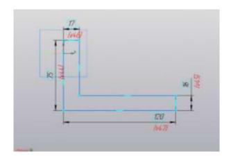
К полученному эскизу применяем операцию Элемент выдавливания. (на 90 мм)
