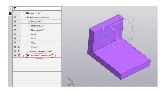
В дереве выделяем смещенную плоскость 1, нажимаем эскиз и строим отрезок.
