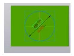
Применяем операцию выдавливания и получаем цилиндр.
