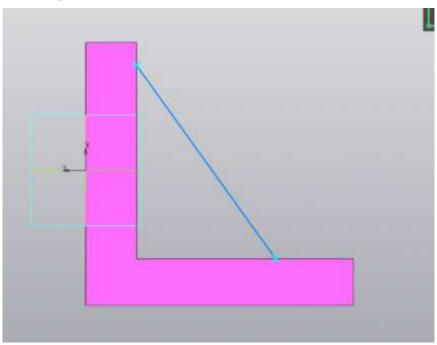
Выходим из эскиза и выбираем инструмент Ребро жесткости. (толщина – 15 мм)
