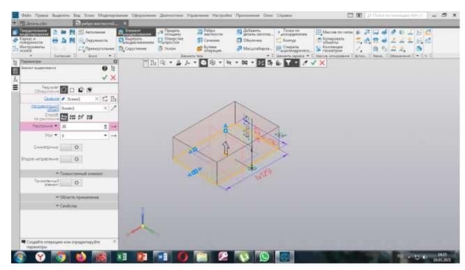
Выделяем верхнюю грань. Нажимаем эскиз и рисуем окружность диаметром 50.
