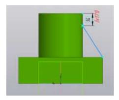
Выходим из эскиза, применяем инструмент Ребро жесткости с толщиной 10 мм.
