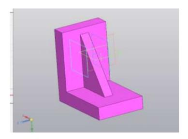
Выполняем скругления радиусом 37 мм.
