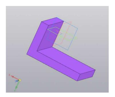
Переходим к построению ребра жесткости. Для этого построим смещенную плоскость.
