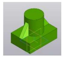
Повторяем операцию и получаем второе ребро жесткости.
