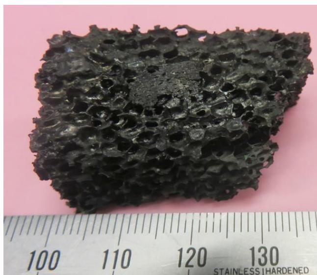
Рисунок 1 – Первые образцы сверхпроводниковой пены
