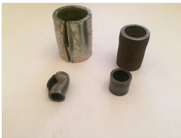
Рис. 5 Втулки после осадки
