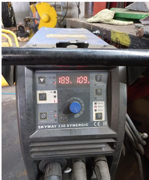
Рис. 4 SKYWAY 330 – 3-х фазный синергетический инвертор для полуавтоматической сварки
