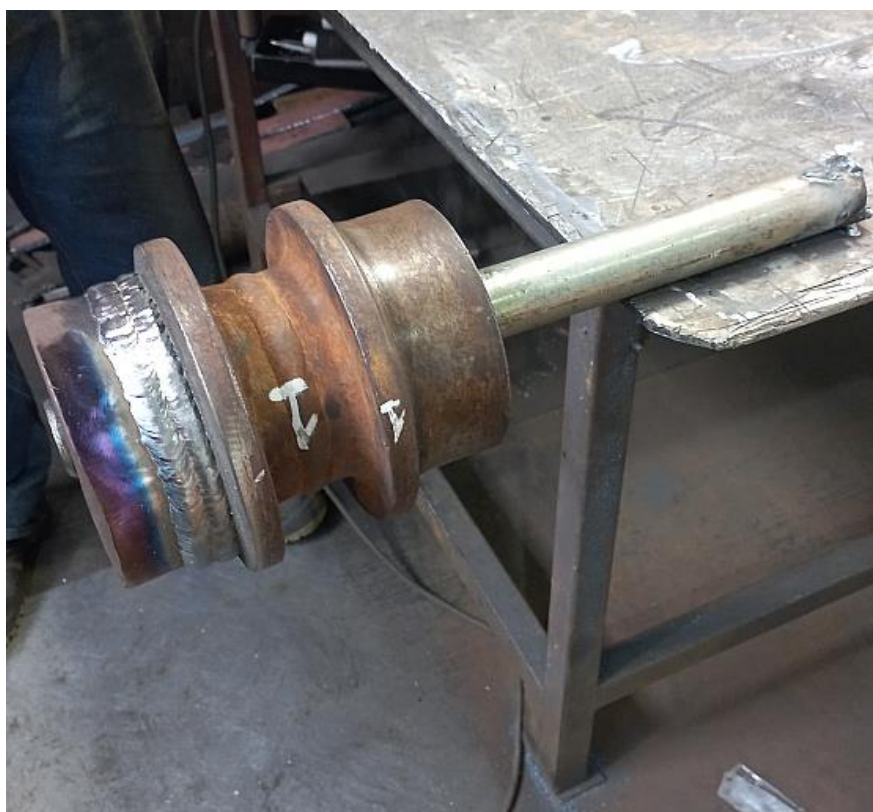
Рис. 5 Образец наплавленного валика
