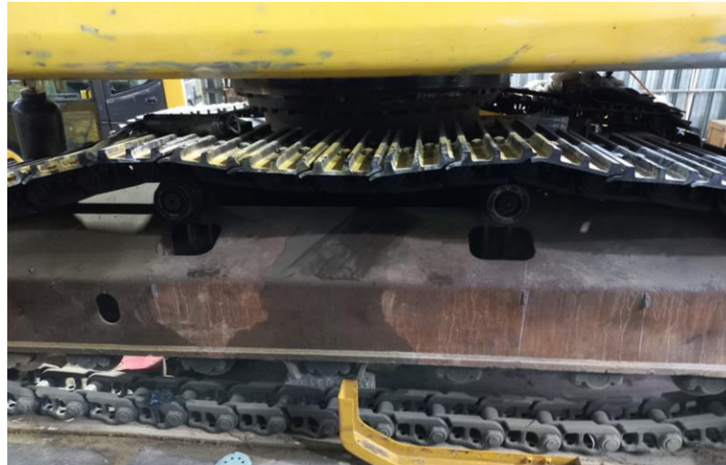
Рис.2 Поддерживающий каток ходовой части экскаватора
