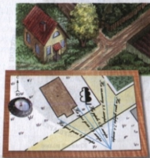
Рис. 47. Полярная глазомерная съёмка
