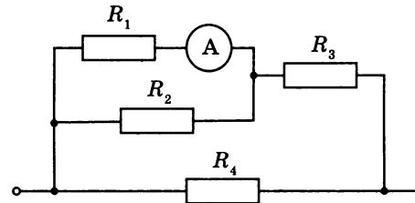
**262.** В электрической цепи (см. рисунок) известно, что амперметр  $A_0$  показывает 5 мА, амперметр  $A_3$  показывает 1 мА; значения сопротивлений  $R_1 = 3$  Ом,  $R_2 = 1$  Ом. Найдите показание амперметра  $A_2$ .
