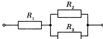
**213.** Определите общее сопротивление цепи, изображенной на рисунке. Сопротивления резисторов:  $R_1 = 12 \text{ Ом}$ ,  $R_2 = 6 \text{ Ом}$ ,  $R_3 = 4 \text{ Ом}$ ,  $R_4 = 3 \text{ Ом}$ ,  $R_5 = 5 \text{ Ом}$ ,  $R_6 = R_7 = R_8 = 30 \text{ Ом}$ .
