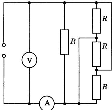
**266.** В схеме, изображенной на рисунке, сопротивления резисторов:  $R_1 = 12 \text{ Ом}$ ,  $R_2 = 3 \text{ Ом}$ ,  $R_3 = 6 \text{ Ом}$ ,  $R_4 = 4 \text{ Ом}$ . Найдите токи, протекающие через каждый резистор, если напряжение на концах цепи  $U = 24 \text{ В}$ .
