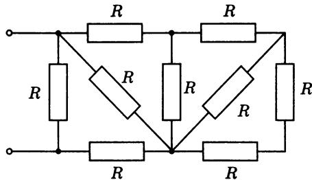
**228.** Сопротивление каждого из резисторов, включенных в цепи, равно  $30 \text{ Ом}$  (см. рисунок). Определите сопротивление этих цепей. Сопротивлением соединительных проводов можно пренебречь.
