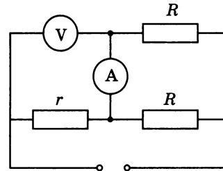
**269.** Что будет показывать амперметр, если на цепь (см. рисунок) подать напряжение  $6 \text{ В}$ ? Сопротивления резисторов:  $R_1 = R_4 = R_6 = 6 \text{ Ом}$ ,  $R_2 = 9 \text{ Ом}$ ,  $R_3 = 3 \text{ Ом}$ ,  $R_5 = 4 \text{ Ом}$ .
