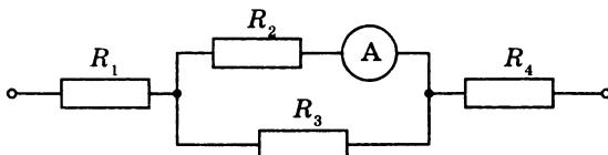
**261.** На рисунке изображена схема смешанного соединения четырех резисторов. Найдите токи, проходящие через каждый резистор, и напряжения на них, если показание амперметра 1 А,  $R_1 = 8$  Ом,  $R_2 = 8$  Ом,  $R_3 = 6$  Ом,  $R_4 = 10$  Ом.
