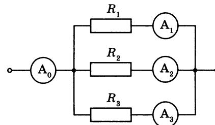
**263.** Резисторы  $R_2 = 200$  Ом и  $R_3 = 500$  Ом соединены параллельно, последовательно с ними включен резистор  $R_1 = 100$  Ом. При подключении этой цепи к источнику тока за 10 с через третий резистор прошел заряд 0,5 Кл. Определите напряжение на концах цепи (см. рисунок).
