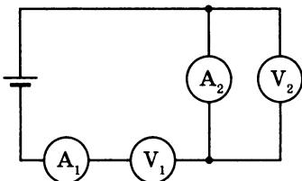
**271.** Сопротивление резистора измеряют по двум электрическим схемам (см. рисунок). В схеме *а* показание вольтметра 190 В, амперметра – 1,9 А; в схеме *б* показание вольтметра 170 В, амперметра – 2 А. Используя эти результаты, найдите сопротивление резистора. Напряжение на концы каждой схемы подается одинаковое.
