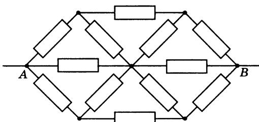
**230.** Определите сопротивление проволочных каркасов между точками  $A$  и  $B$ , если сопротивление одного звена  $6 \text{ Ом}$  (см. рисунок).
