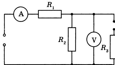
**268.** Определите показания приборов, если напряжение на концах цепи  $45 \text{ В}$ , а сопротивления, используемые в схеме:  $R = 50 \text{ Ом}$ ,  $r = 20 \text{ Ом}$ . Амперметр и вольтметр идеальные (см. рисунок).
