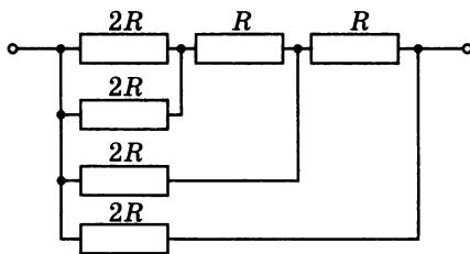
**222.** Определите общее сопротивление схемы, если сопротивление каждого резистора  $R = 3$  Ом (см. рисунок).
