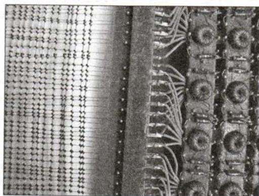
Рис. 5.13. Магнитное ОЗУ: слева — биты памяти, справа — устройство выборки нужного адреса
