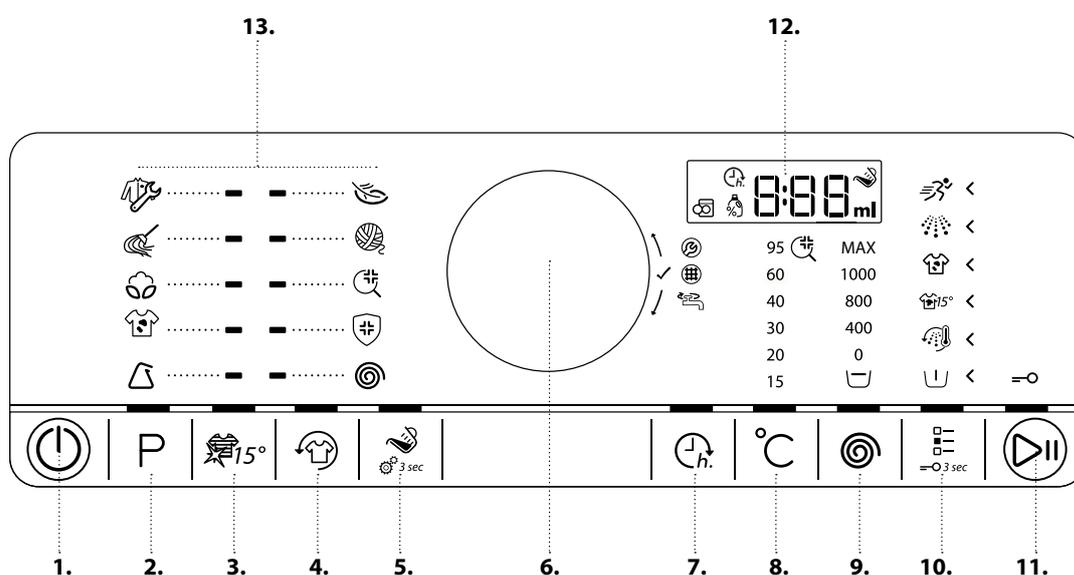
1. Кнопка "Вкл/Выкл" ("Сброс/Слив" при длительном нажатии)
