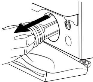
**5.** Очистите фильтр: Удалите твердые загрязнения и промойте фильтр в проточной воде.
