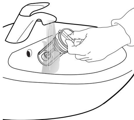
**6.** Вставьте фильтр и установите на место нижнюю панель: Вставьте фильтр, закрутив его в направлении по часовой стрелке. Убедитесь, что фильтр закручен до упора: ручка фильтра должна располагаться вертикально. Для проверки герметичности фильтра можно налить примерно 1 литр воды в лоток для моющих средств. Затем установите на место нижнюю панель.
