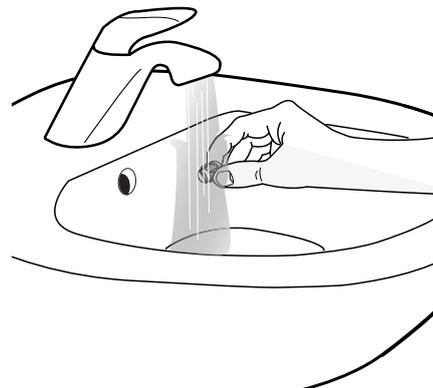
**4.** Установите сетчатый фильтр на место. Подсоедините заливной шланг к крану подачи воды и стиральной машине. Для подсоединения шланга не используйте инструменты. Откройте кран подачи воды и проверьте герметичность всех соединений.
