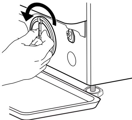
**4.** Снимите фильтр: Разместите под фильтром тряпку для сбора небольших остатков воды. Снимите фильтр, вывинтив его в направлении против часовой стрелки.
