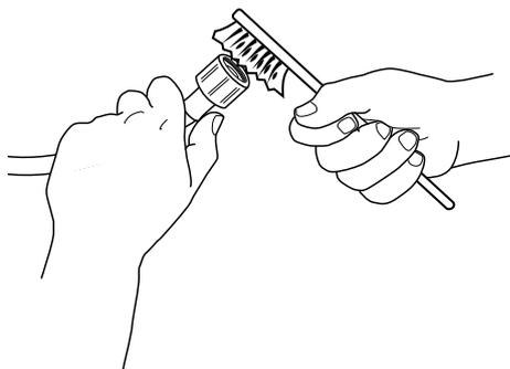
**3.** Далее, вручную открутите заливной шланг от патрубка на задней стороне стиральной машины. Используя плоскогубцы, вытяните сетчатый фильтр из патрубка и тщательно очистите его.
