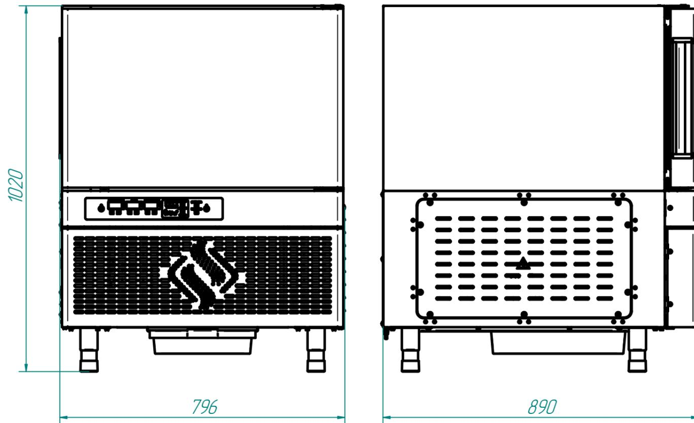
Аппарат шоковой заморозки ШОК-4-1/1 предназначен для быстрого охлаждения и замораживания различных пищевых продуктов на предприятиях общественного питания и торговли.
