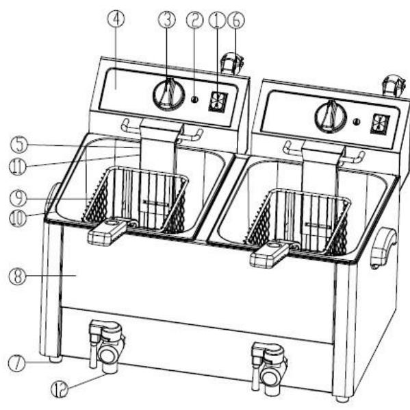
1. КНОПКА ВКЛ. 2. СВЕТОВОЙ ИНДИКАТОР 3 КОНТРОЛЛЕР ТЕМПЕРАТУРЫ
