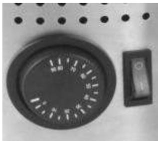
Аппарат также оснащен вторым термостатом (на дне машины), который используется для регулировки температуры донной пластины. Данный термостат калибруется на заводе и выставляется при обычных условиях эксплуатации на 120°C. Не рекомендуется изменять заводскую установку данного термостата без предварительной консультации с вашим поставщиком оборудования. Тем не менее, изменение значения температуры, заданной с помощью этого термостата, приводит к изменению времени нагрева продукта.
