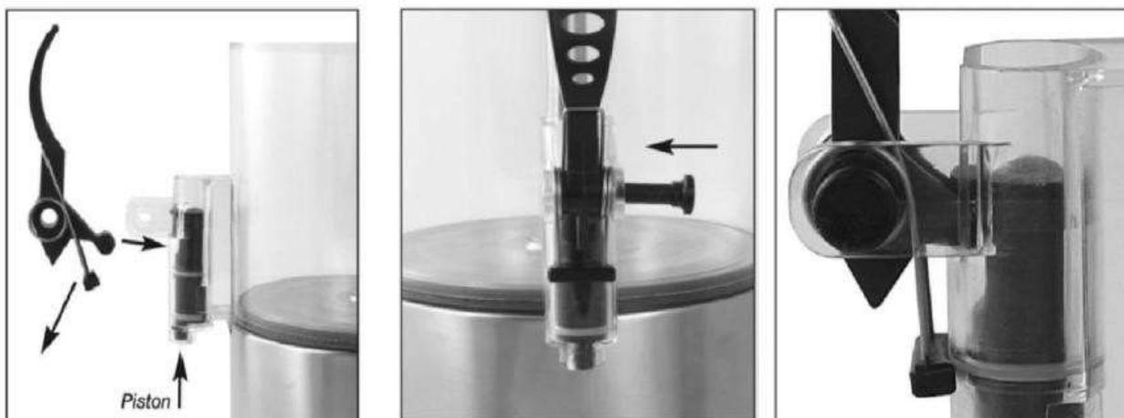
По окончании сборки аппарата проверьте кран на предмет протечки. Если кран подтекает, первоначально проверьте правильность сборки крана. Если течь продолжается, проверьте резиновое уплотнение крана. При необходимости замените его.
