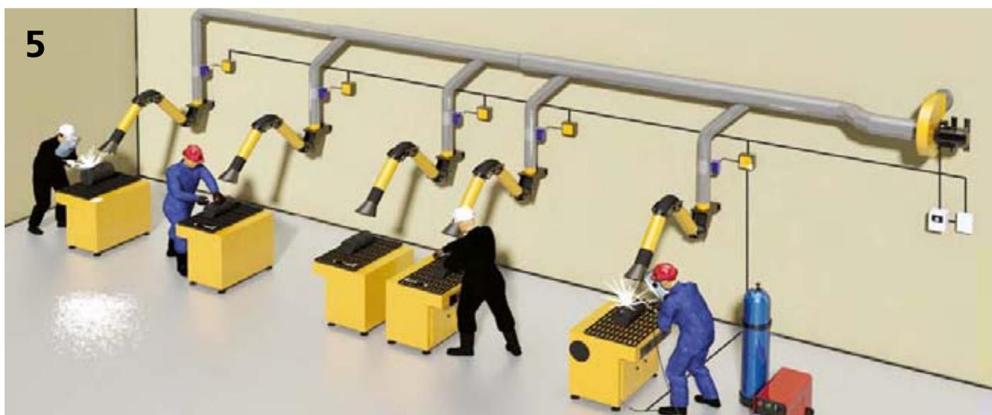
Центральная энергосберегающая система высокой эффективности: KUA-M – 3 шт, индукционный или световой датчик – 3 шт, автоматическая заслонка AD с пультом ICE-LC – 3 шт, устройство согласования сигналов УСС, преобразователь частоты, центральный вентилятор FUK или FTEV. Модель вентилятора подбирается в зависимости от максимального количества существующих, либо одновременно работающих постов.
