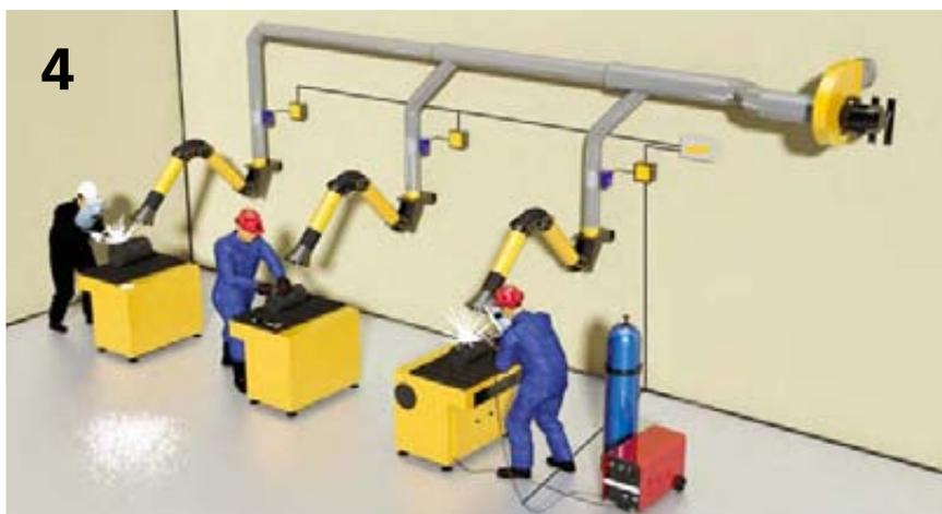
Центральная энергосберегающая система: KUA-M – 3 шт, индукционный или световой датчик – 3 шт, автоматическая заслонка AD с пультом ICE-LC – 3 шт, устройство PCU-1000, центральный вентилятор FUK. Модель вентилятора подбирается в зависимости от максимального количества существующих, либо одновременно работающих постов.
