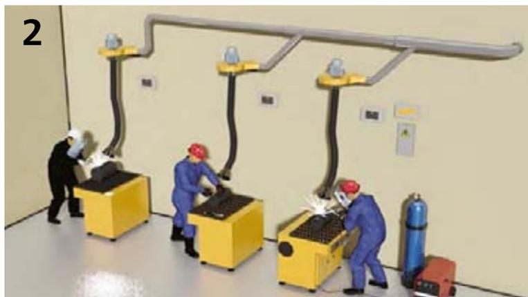
\*Центральная система: 3 x LM-2 с отдельными вентиляторами и устройствами PCU-1000 и датчиками MCC-05, подключенными к центр. вентилятору в воздуховоде.
