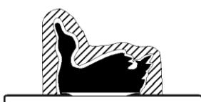
Покройте оригинал алюминиевой фольгой, а поверх нее – толстым слоем (не менее 1 см) пластилина или глины.
