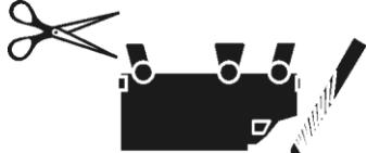
Удалите пластиковые трубы и отрежьте лишние отростки отливки. Обработайте заусенцы мелким напильником или наждачной бумагой.
