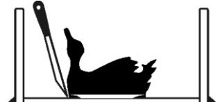
Подготовьте формовочный короб из дерева, пластика или металла. Зазор вокруг оригинала должен быть не менее 25 мм. Поместите полоску пластилина на дно короба по контуру нижней стороны оригинала. Вдавите нижнюю сторону оригинала в пластилин. Удалите весь выступающий пластилин.
