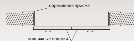
Установка перегородки вне проема
