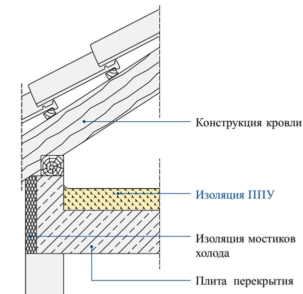
Изоляция чердачного бетонного перекрытия
