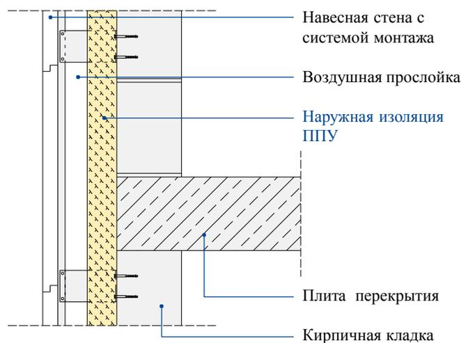
Наружная стена с термоизоляцией и навесной вентилируемой облицовкой
