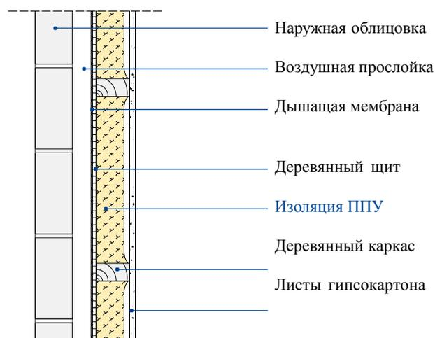
Деревянная каркасная конструкция с термоизоляцией между элементами каркаса и вентилируемой наружной облицовкой (горизонтальное сечение)
