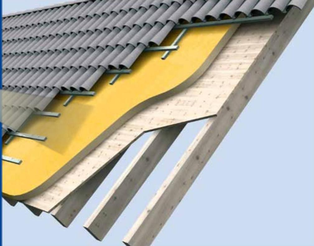
При термоизоляции над балками кровли изоляционный материал наносится на кровельную доску, уложенную на балки, и только после этого кроется крыша. Балки и кровельная доска при этом остаются видимыми изнутри здания. Этот вид изоляции является преимущественным, если есть необходимость в сохранении тепла. Идеально подходит для мансардных помещений.
