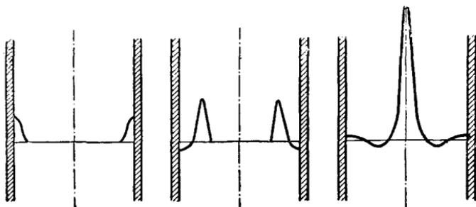
Рис. 8. Распределение плотности тока по сечению разрядной трубки в разные моменты времени.
