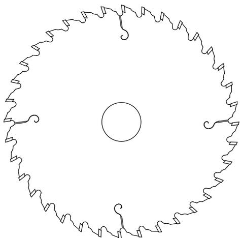
Алмазная подрезная пила тип **PD-408** – это пила с резцами из поликристаллического алмаза DP (DIA) с трапецидальным зубчатым венцом (GR/GM, GR/GS), предназначена для резки однородных, без загрязнений, материалов на автоматических и ручных обрабатывающих линиях.
