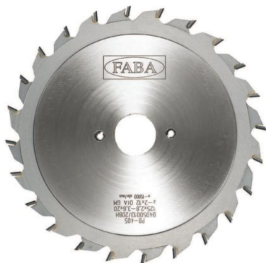
Алмазная подрезная пила тип **PD-405** – это набор пил с регулицией, состоящий из двух пил, с резцами из поликристаллического алмаза DP (DIA) с прямым зубчатым венцом GM, предназначен для резки однородных, без загрязнений, материалов на автоматических обрабатывающих линиях. Регуляция ширины набора осуществляется с помощью прокладок.
