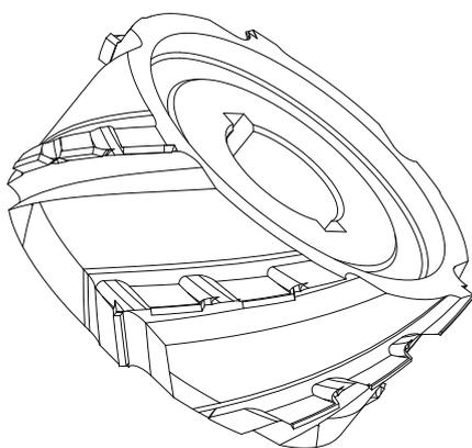
Фреза насадная прямая тип **FD-025** предназначена для форматирования поверхности на станках с механической подачей. Направленные по спирали под большим осевым углом режущие линии обеспечивают хороший отвод стружки, тихую и стабильную работу, повышают износостойкость фрезы, сохраняя при этом высокое качество.
