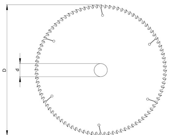
Алмазная универсальная пила тип **PD-505** – это пила с резцами из поликристаллического алмаза DP (DIA) с переменнo-косым зубчатым венцом GS, предназначена для продольной и поперечной резки клееного дерева, фанеры, ДСП на автоматических и ручных обрабатывающих линиях.
