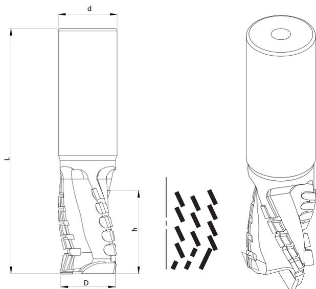
Фрезы концевые прямые „turbo” тип **TDT-01** для форматирования и разрезания на цифровых станках с ЧПУ.
