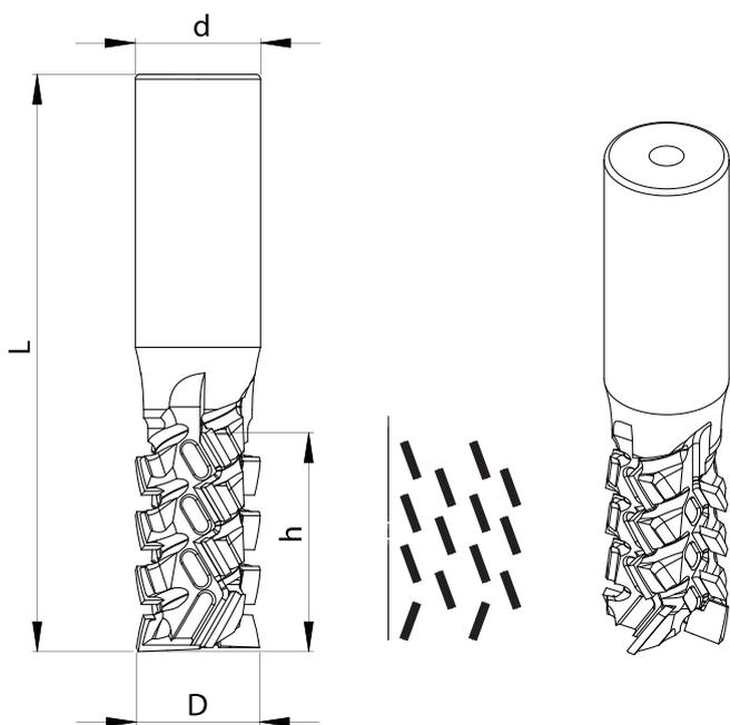
Фрезы концевые прямые „turbo” тип **TDT-10**  $z=4+4$  предназначены для форматирования, разрезания, выборки пазов и копирования на цифровых станках с ЧПУ.
