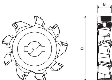
Фреза насадная прямая тип **FD-03** предназначена для предварительной обработки перед профилированием оклеенных элементов.
