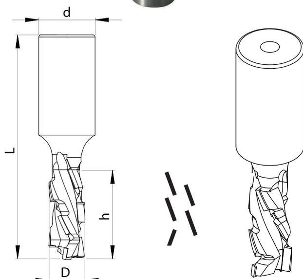
Фрезы концевые прямые „turbo“ тип **TDT-07** предназначены для форматирования и разрезания на цифровых станках с ЧПУ.
