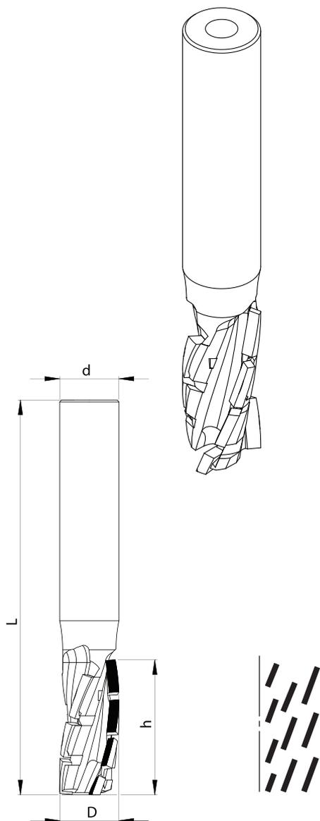
Фрезы концевые прямые „turbo” тип **TDT-15** предназначены для форматирования и разрезания на цифровых станках с ЧПУ.
