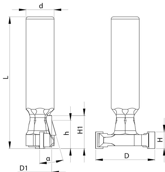
Фрезы концевые профильные тип **TPD-18** предназначены для обработки Т-пазов.
