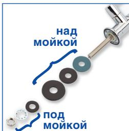
**6.** Наденьте на резьбовой хвостовик крана декоративную подставку, резиновую прокладку и резиновую шайбу
