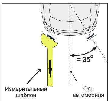
Удостоверьтесь, что рабочая поверхность радаров и его боковые стороны **вертикальны** земле, а угол между осью направленной диаграммы установленного радара и продольной осью кузова автомобиля составляет 35 градусов. Проверьте направление осей радаров с помощью измерительного шаблона. Убедитесь, что оси диаграмм радаров направлены во внешнюю часть автомобиля. Избегайте ошибок представленных на иллюстрации.
