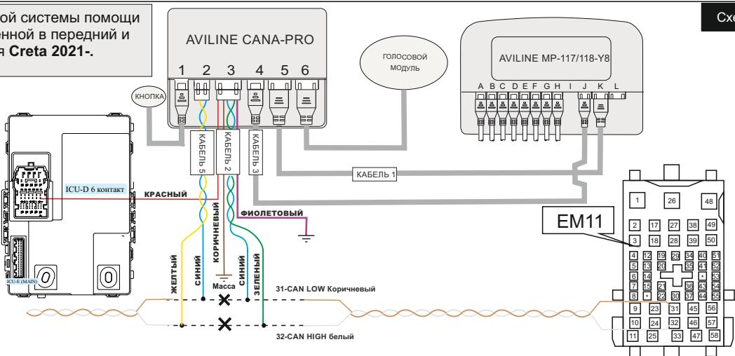
Схема подключения 4-х датчиковой системы помощи при парковке AVILINE, установленной в переднем бампере, на автомобиле Creta 2021-, оборудованном штатным ассистентом парковки
