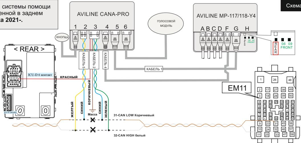
Схема подключения 8-ми датчиковой системы помощи при парковке AVILINE, установленной в передний и задний бампера автомобилей Creta 2021-.
