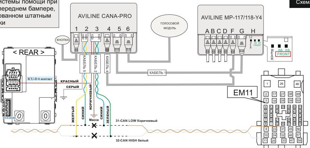
Разъем EM11 находится в левой водительской кик-панели (вид разъема со стороны проводов); разъем ICU-D находится на задней части блока предохранителей над левой ногой водителя.
