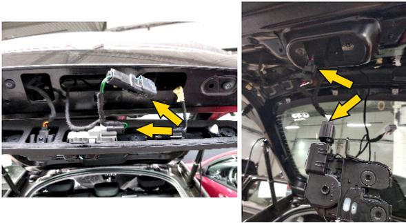
10. Подключите к разъему "I" блока управления соединительный кабель. Через его проходные разъемы Pin-to-Pin, подключите разъем кабеля замка двери багажника и разъем кабеля штатной кнопки открытия багажника
