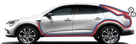
16. Демонтируйте декоративные наклейки порогов водительской стороны салона а/м. Уложите соединительный кабель питания блока управления и кабель передней кнопки вдоль штатной проводки а/м в направлении передней части торпедо, фиксируя пластиковыми стяжками по всей длине кабеля с промежутками 150-200 мм.
