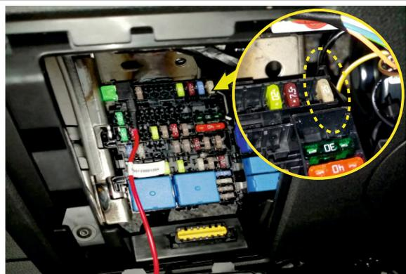
20. Коннектор питания с предохранительной колодкой из комплекта поставки установите вместо штатного предохранителя на 25А, в верхнем ряду, в блоке предохранителей. Штатный предохранитель на 25А установите в коннектор питания.
