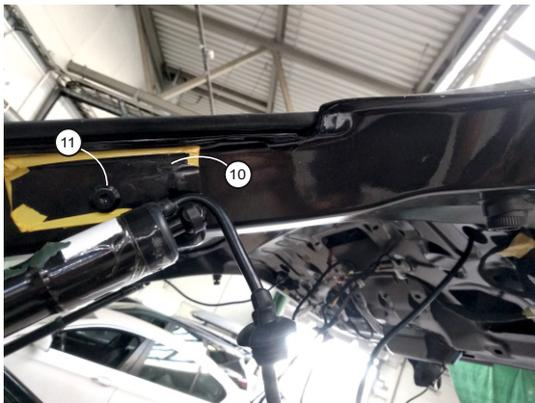
6. Присоедините электроприводы, соблюдая маркировку «L» и «R», к установленным шарообразным кронштейнам, таким образом, чтобы место из которого выходит кабель находилось ближе к кронштейну расположенному на двери.
