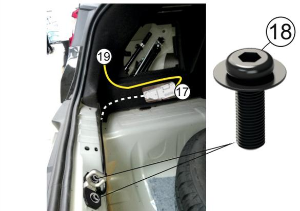
15. Установите моторизованную петлю плавного закрывания (17) из комплекта. Используя болты крепления (18) , закрепите саму петлю на пороге.
