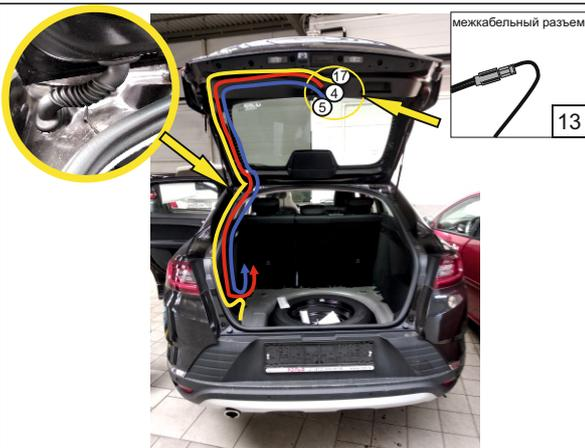
13. Соединительный кабель питания блока управления, кабель передней кнопки и соединительный кабель привода плавного закрывания двери (с моторизованной петлей) подключите к блоку управления к разъемам B, A и C. Соедините 2-х пиновый межблочный разъем с синим проводом около разъемов блока управления A и B. Соедините 2-х пиновый межблочный разъем с коричневым и черным проводом около разъемов блока C и H
