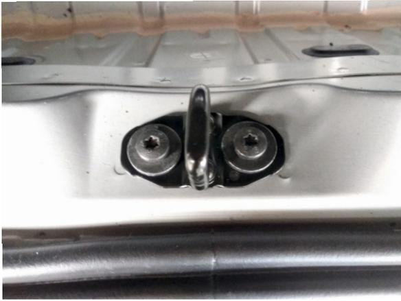
**ВНИМАНИЕ!** Перед выполнением работ убедитесь, что при закрытых боковых дверях с поднятыми в них стеклах, дверь багажника закрывается без прикладывания усилий. В противном случае необходимо её отрегулировать.
