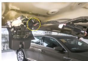
12. Через проходные разъемы кабеля блока управления подключите разъемы кабелей штатной кнопки открытия и замка задней двери.
