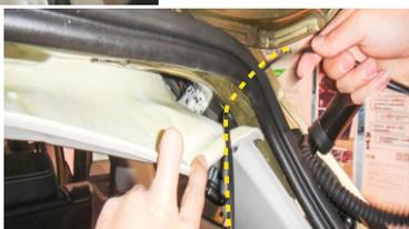
15. Подсоедините кабели питания электрических приводов к разъёмам блока управления (разъёмы H, I, J), предварительно проложив их внутрь двери через технологические отверстия.
