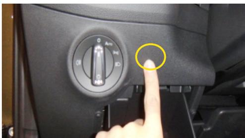
9. При отсутствии штатной кнопки открытия замка багажника, выберите место для установки кнопки из комплекта.
