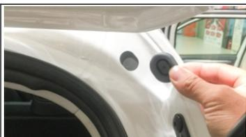
14. Подключите звуковой излучатель к соответствующему разъёму проводки. Установите звуковой излучатель, закрепив его на металлической части двери.
