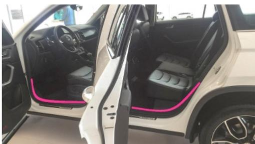
10. Демонтируйте декоративные обшивки порогов водительской стороны салона а/м. Уложите питающий кабель вдоль штатной проводки а/м в направлении задней двери, фиксируя пластиковыми стяжками по всей длине кабеля с промежутками 150-200 мм.
