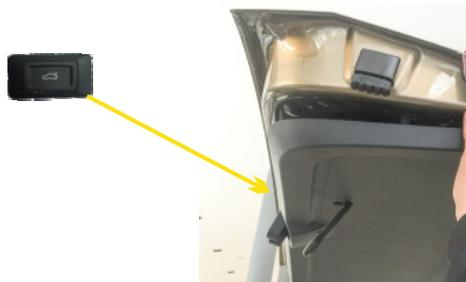
16. Фрезой из комплекта просверлите отверстие в обшивке задней двери, установите в неё кнопку управления и подключите разъём.
