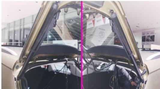
5. Присоедините электроприводы, соблюдая маркировку «L» и «R», к установленным шарообразным кронштейнам, таким образом, чтобы место из которого выходит кабель находилось ближе к кронштейну расположенному на кузове.
