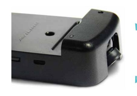
Объектив видеорегистратора регулируется по вертикальной оси для настройки области видеофиксации
