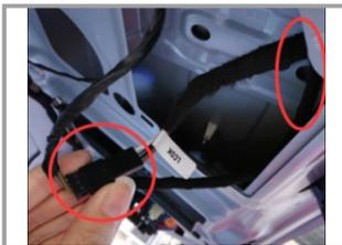
12. Через «проходной» кабель подключите разъем штатного электрического замка крышки багажника
