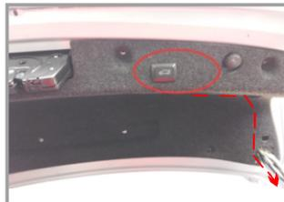
13. Установите кнопку открытия крышки багажника. Проложите кабели вдоль штатной проводки. Установите обшивку крышки багажника
