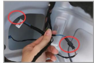
11. Через «проходной» кабель подключите разъем штатной кнопки открытия крышки багажника
