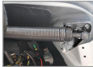
10. Защелкните шаровый шарнир электропривода
