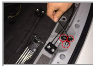
18. Вместо штатной петли замка установите привод «дожима» замка крышки багажника
