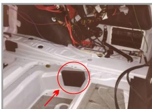
20. Зафиксируйте подложку для электропривода механизма «дожима»
