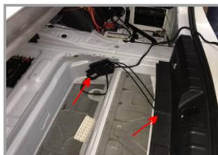
20. Зафиксируйте электропривод механизма «дожима»
