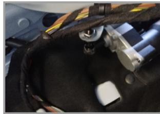
9. Защелкните шаровый шарнир электропривода
