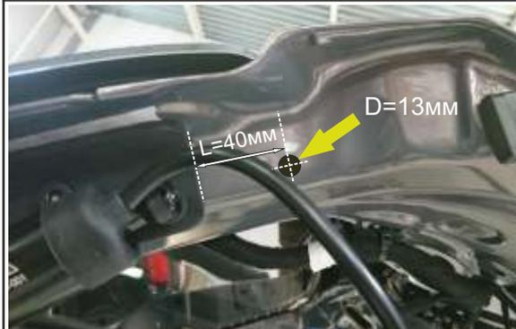
11. На расстоянии 40мм от кронштейна в левой части двери багажника, как показано на фото, просверлите сверлом 3мм отверстие, затем изготовьте отверстие фрезой 13мм (20). Обработайте края отверстий в металле антикоррозионным средством.
