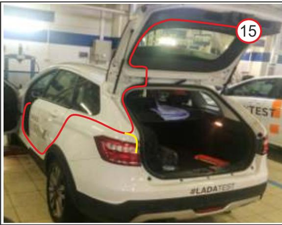
17. Демонтируйте декоративные обшивки порогов водительской стороны салона а/м. Уложите соединительный кабель питания блока управления (15) вдоль штатной проводки а/м в направлении левой части торпедо, фиксируя пластиковыми стяжками по всей длине кабеля с промежутками 150-200 мм.
