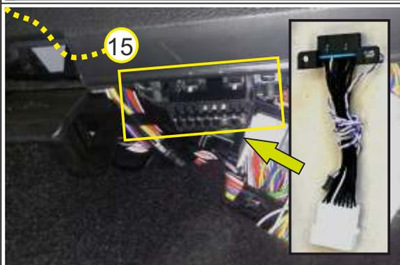
20. Демонтируйте диагностический разъем OBD и вставьте на его место проходной соединительный кабель (19), предварительно соединив его по технологии Pin-to-Pin со штатным разъемом OBD. Подключите 2-х пиновый разъем CAN шины к соответствующему разъему кабеля CAN - модуля (5).
