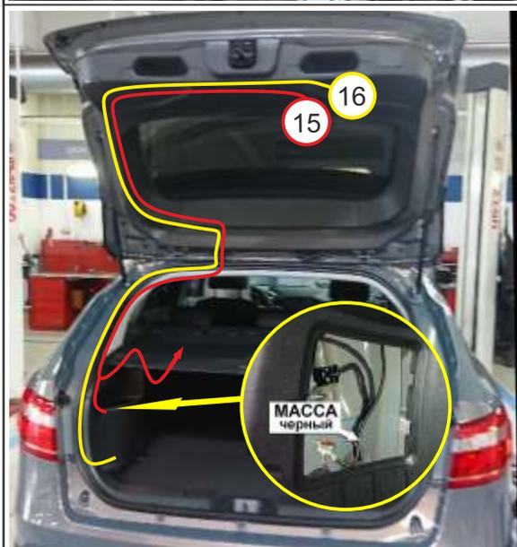
13. Соединительный кабель питания блока управления (15) и соединительный кабель привода плавного закрывания двери с моторизованной петлей (16) подключите к блоку управления к разъемам E, F и G. Соедините 2-х пиновый межблочный разъем с синим проводом около разъемов блока управления E и F.
