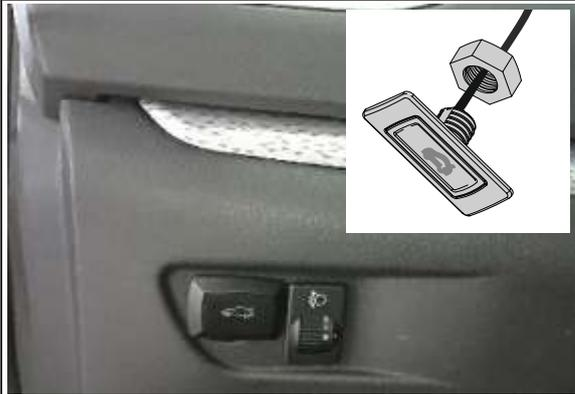
18. Выберите место для установки кнопки управления (6) из комплекта. Используя фрезу 16мм (13) просверлите отверстие. Установите кнопку в сформированное отверстие. Подключите разъем кнопки к разъему кабеля CAN блока (5).
