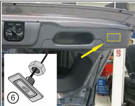
23. Фрезой (13) из комплекта просверлите отверстие 16мм в штатной заглушке обшивки задней двери, установите кнопку управления (6) зафиксировав её креплением из комплекта поставки, затем подключите разъем к разьему соединительному кабелю звукового излучателя и кнопки управления (17).
