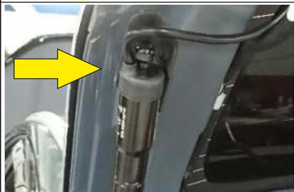
5. Присоедините электроприводы (2) и (3), соблюдая маркировку «L» и «R», к установленным шарообразным кронштейнам, таким образом, чтобы место из которого выходит кабель находилось ближе к кронштейну расположенному на двери багажника.
