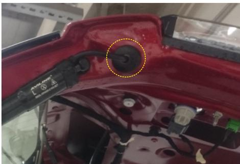
13. Для подключения звукового излучателя используйте кабель соответствующий разъему (B) блока управления. Установите звуковой излучатель, закрепив его на металлической части двери.
