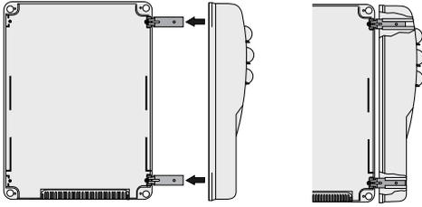
6) После проведения всех регулировок и подключений закройте и зафиксируйте дверцу прилагающимися шурупами.
