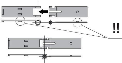
4) Вставьте петли в пазы корпуса (справа или слева по Вашему желанию) и закрепите их с помощью прилагаемых винтов и шайб.
