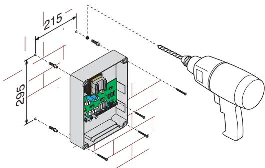
2) Рассверлите отверстия для гермовводов. Установить гермовводы с гофрированным шлангом для электрических кабелей. Примечание: диаметр отверстий 20мм.
