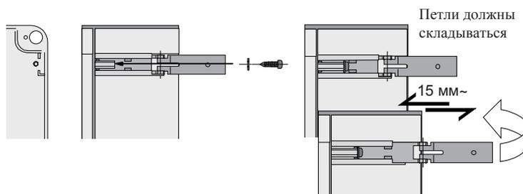
5) Установите дверцу корпуса на петли и закрепите прилагающимися винтами.
